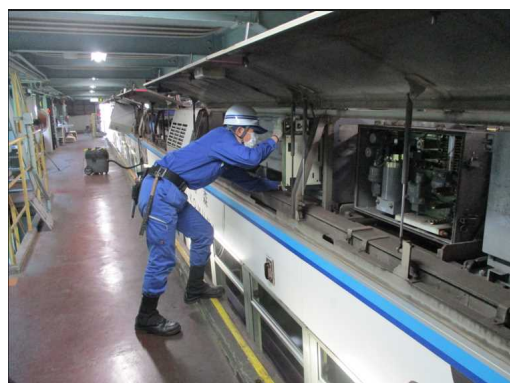
車両屋根上点検（検修庫）
