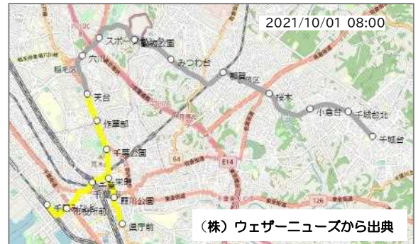
強風警報画面(例) 灰色線:風速15m/s超予測 黄色線:風速20m/s超予測 (赤色線:風速25m/s超予測)
