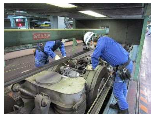
車両屋根上点検（検修庫）
